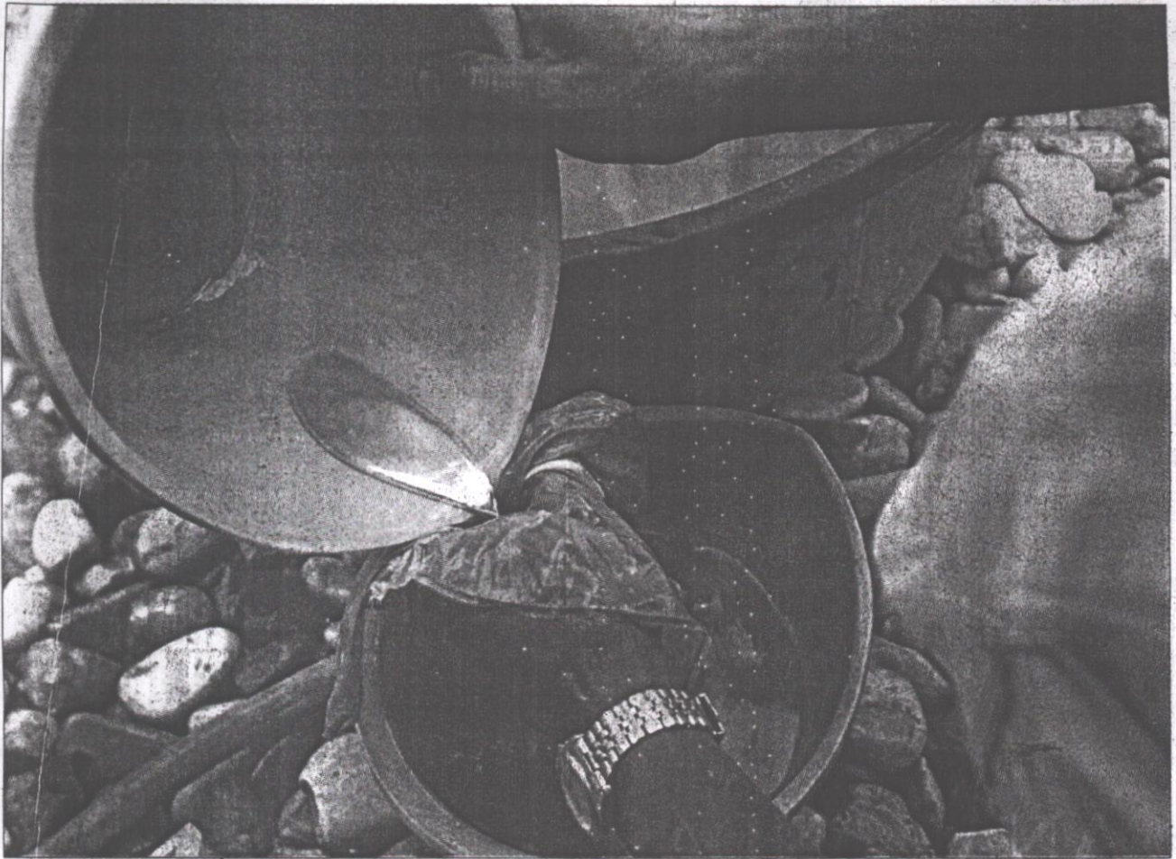
AIR PERAK – Air perak yang telah dipisahkan dari air dituang ke dalam potongan kain untuk diperas hingga berbentuk bulat.
